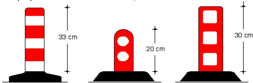
Gli elementi prefabbricati per salvagenti pedonali e **delimitatori di corsia** possono essere realizzati in calcestruzzo, costituiti da sezioni componibili mediante appositi incastri. Essi devono essere impiegati solo nelle zone urbane per la creazione di isole pedonali di rifugio ovvero piattaforme di carico.
