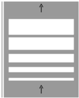
Sulla base delle indicazioni progettuali ovvero della Direzione Lavori, i sistemi di rallentamento ad **effetto acustico** saranno realizzati mediante irruvidimento della pavimentazione stradale ottenuta con la scarificazione o incisione superficiale della stessa o con l'applicazione di strati sottili di materiale in rilievo in aderenza, eventualmente integrato con dispositivi rifrangenti. Tali dispositivi possono anche determinare effetti vibratori di limitata intensità.
